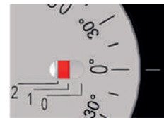
Indicador en posición 2 / Presión alta Stop in position 2 / High pressure
